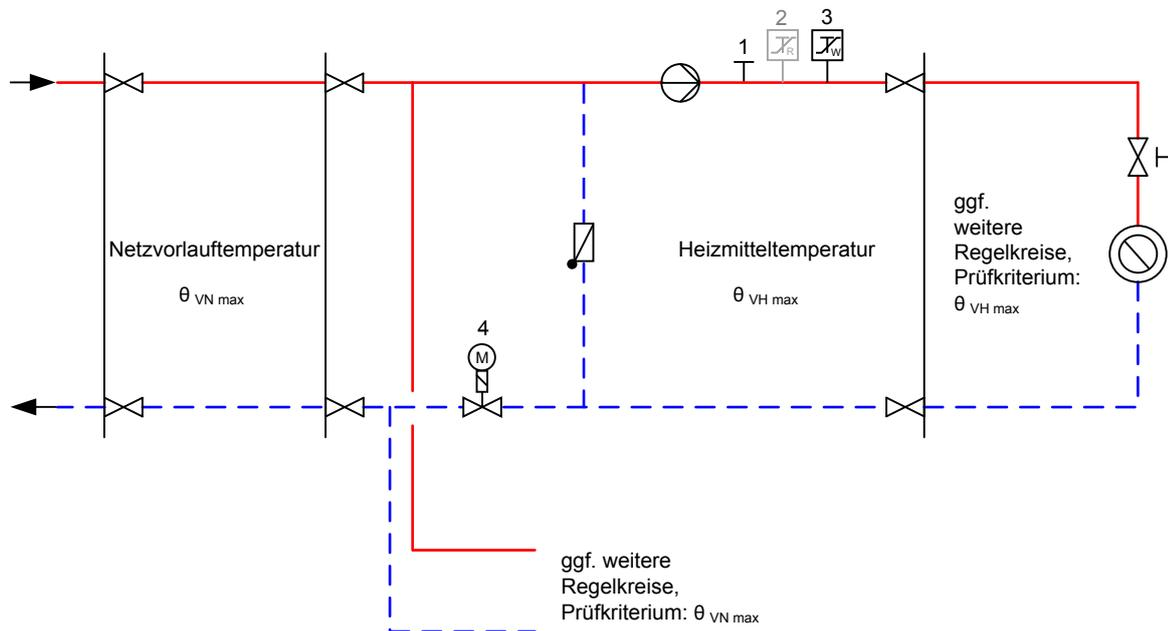
Abbildung zur Tabelle 8: Erforderliche sicherheitstechnische Ausrüstung nach Zeile 2; grau dargestellte Komponenten nicht erforderlich
