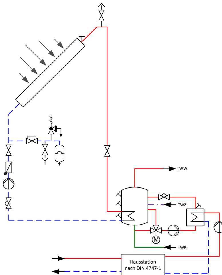
Abbildung 20: Trinkwassererwärmer mit außen liegendem Wärmeübertrager für die Nachheizung
