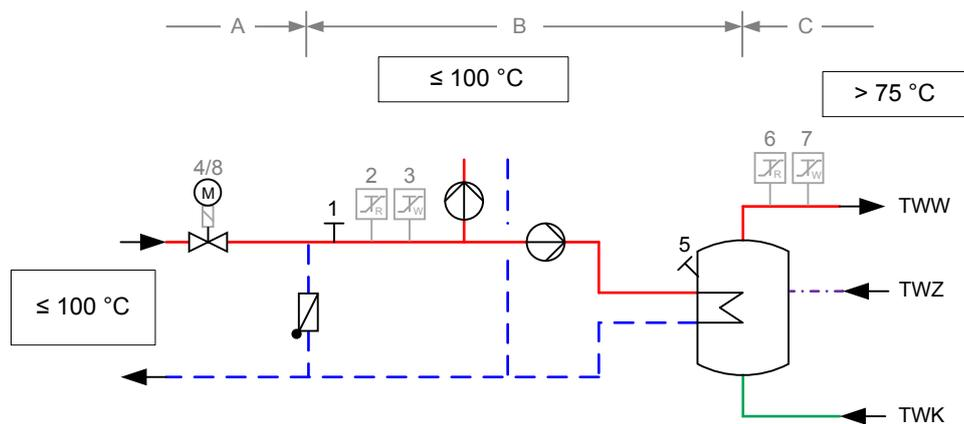
Abbildung zur Tabelle 32: Erforderliche sicherheitstechnische Ausrüstung nach Zeile 3; grau dargestellte Komponenten nicht erforderlich
