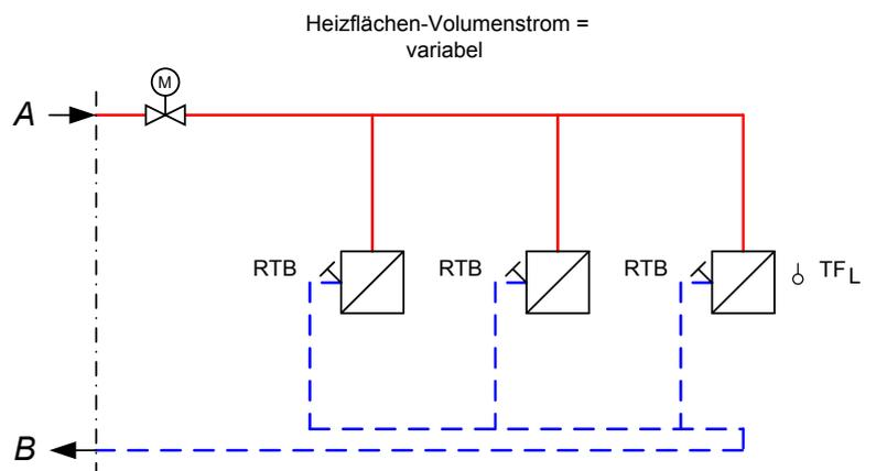
Abbildung 13: Hauszentrale-Raumluftheizung mit drei beispielhaften Hausanlagen, Prinzipschaltbilder für den direkten Anschluss ohne Beimischregelung
