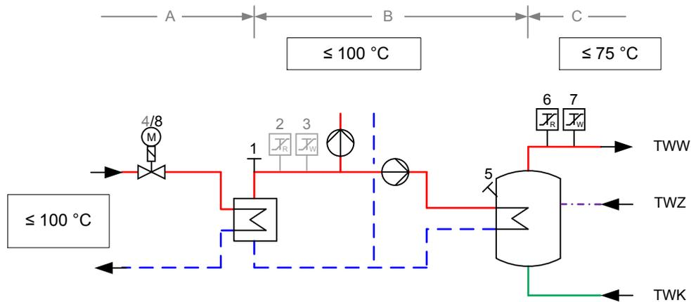
Abbildung zur Tabelle 35: Erforderliche sicherheitstechnische Ausrüstung nach Zeile 2; grau dargestellte Komponenten nicht erforderlich
