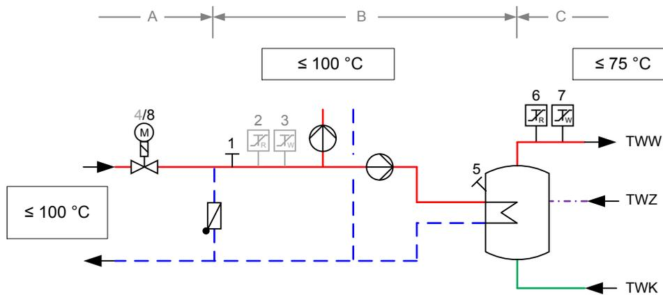
Abbildung zur Tabelle 32: Erforderliche sicherheitstechnische Ausrüstung nach Zeile 2;
