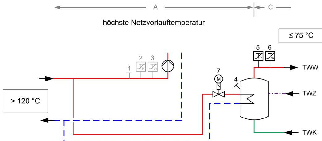
Abbildung zur Tabelle 31: Erforderliche sicherheitstechnische Ausrüstung nach Zeile 1; grau dargestellte Komponenten nicht erforderlich
