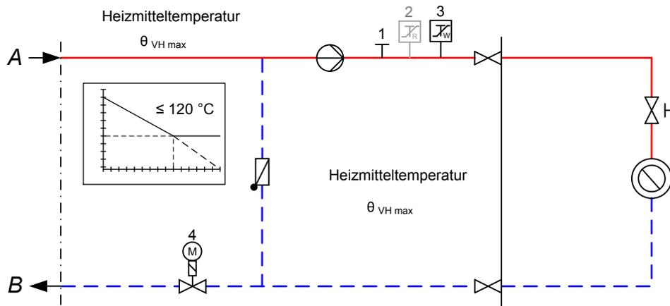
Abbildung zur Tabelle 12: Erforderliche sicherheitstechnische Ausrüstung nach Zeile 5; grau dargestellte Komponenten nicht erforderlich
