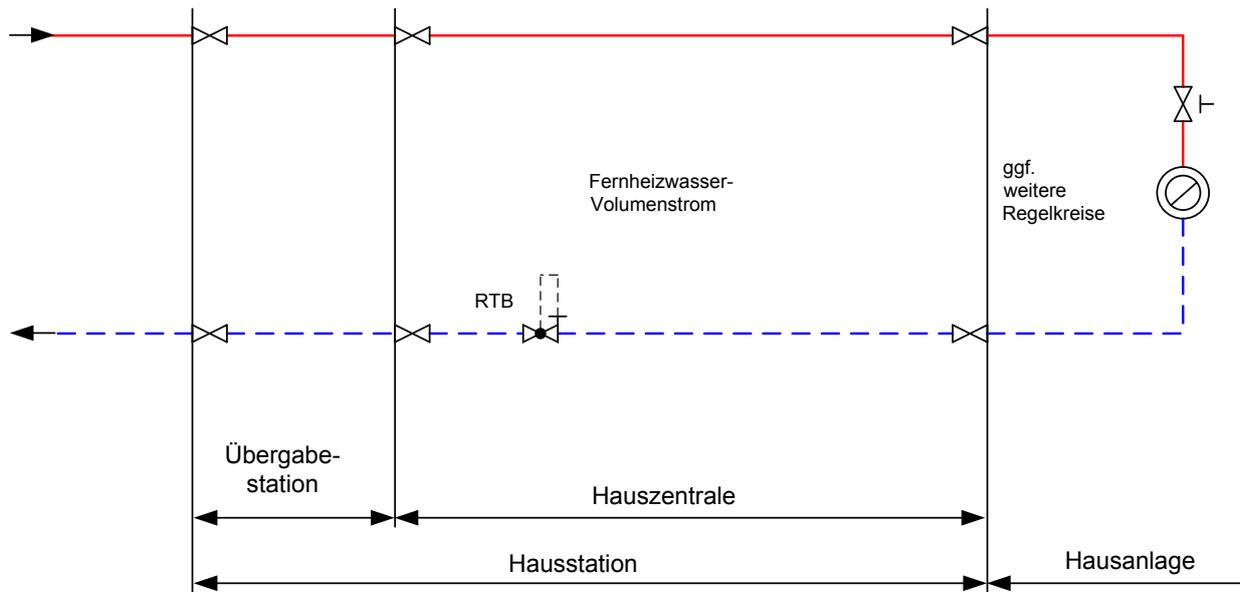
Abbildung 10: Hauszentrale-Raumheizung, Prinzipschaltbild für den direkten Anschluss ohne Beimischregelung
