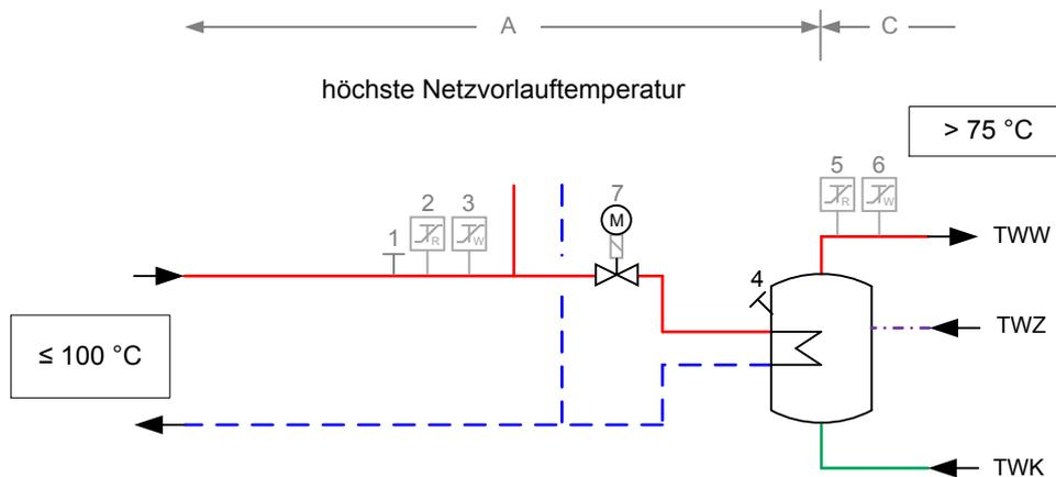
Abbildung zur Tabelle 29: Erforderliche sicherheitstechnische Ausrüstung nach Zeile 2; grau dargestellte Komponenten nicht erforderlich
