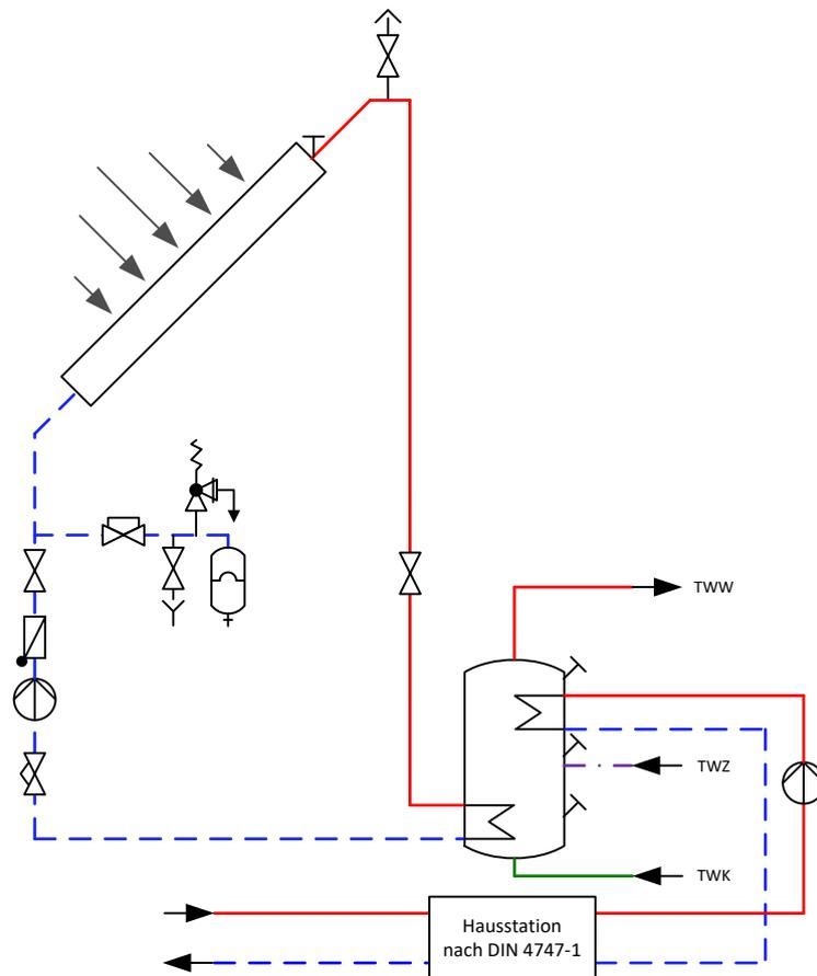
Abbildung 19: Speichersystem mit innen liegenden Heizflächen für Solar und Fernwärme
