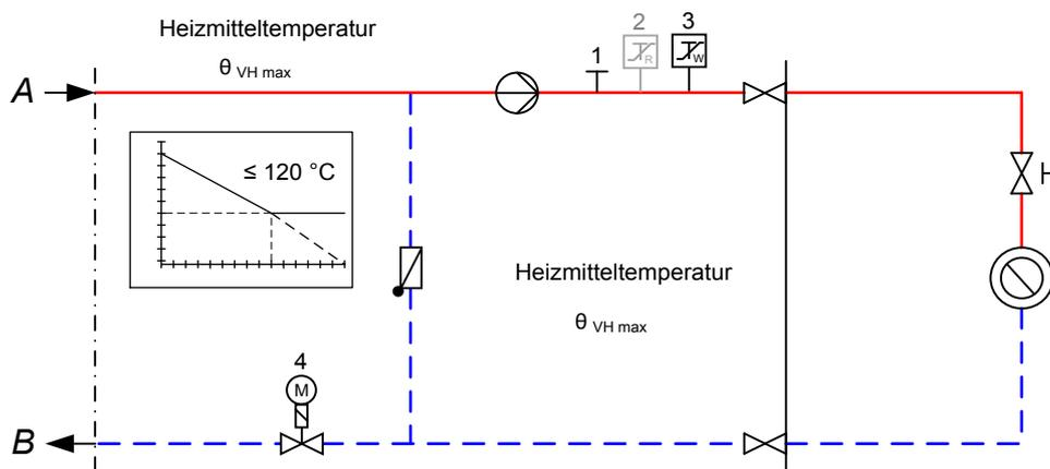
Abbildung zur Tabelle 9: Erforderliche sicherheitstechnische Ausrüstung nach Zeile 4; grau dargestellte Komponenten nicht erforderlich
