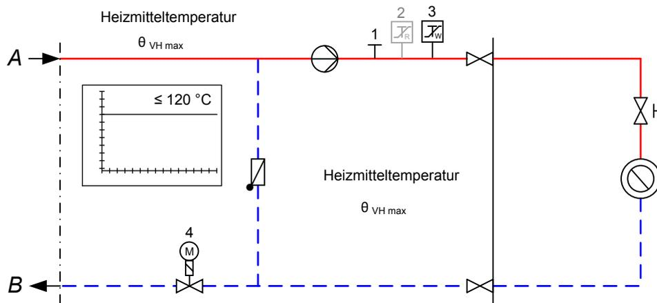
Abbildung zur Tabelle 9: Erforderliche sicherheitstechnische Ausrüstung nach Zeile 2; grau dargestellte Komponenten nicht erforderlich
