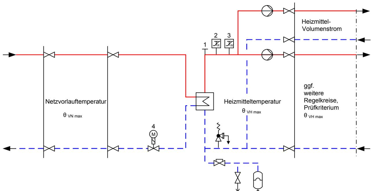
Abbildung zur Tabelle 24: Erforderliche sicherheitstechnische Ausrüstung
