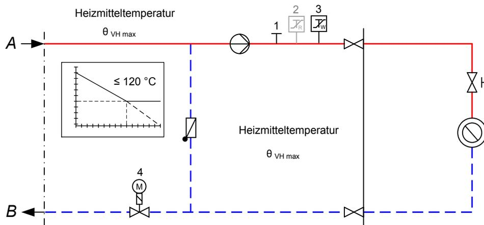
Abbildung zur Tabelle 7: Erforderliche sicherheitstechnische Ausrüstung nach Zeile 5; grau dargestellte Komponenten nicht erforderlich
