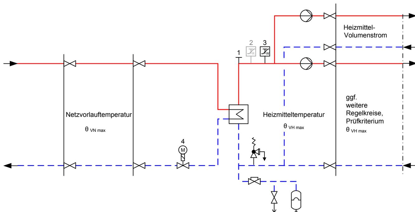
Abbildung zur Tabelle 25: Erforderliche sicherheitstechnische Ausrüstung nach Zeile 2; grau dargestellte Komponenten nicht erforderlich
