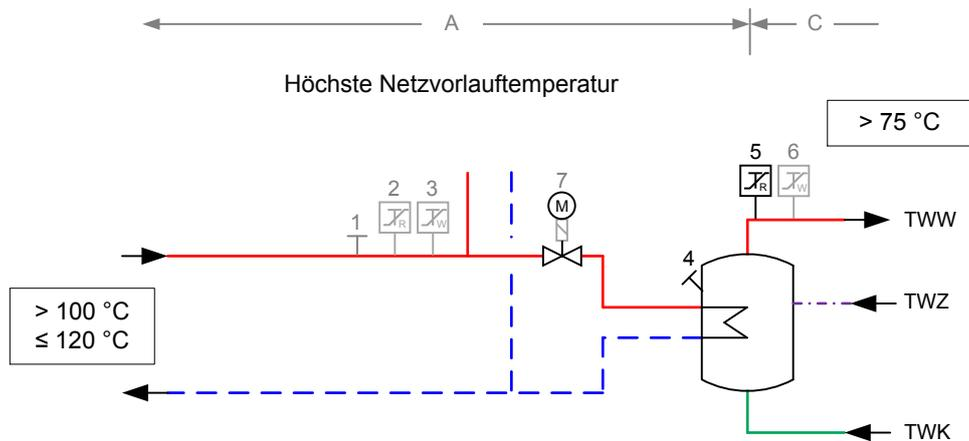
Abbildung zur Tabelle 30: Erforderliche sicherheitstechnische Ausrüstung nach Zeile 2; grau dargestellte Komponenten nicht erforderlich
