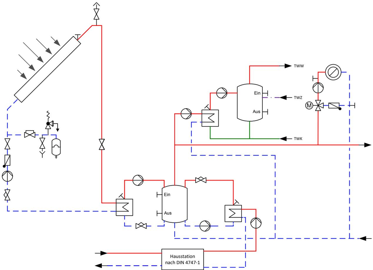
Abbildung 22: Solar unterstütztes Heizsystem, Pufferspeicher mit außen liegenden Wärmeübertragern für die Solaranlage und die Nachheizung mit Fernwärme
