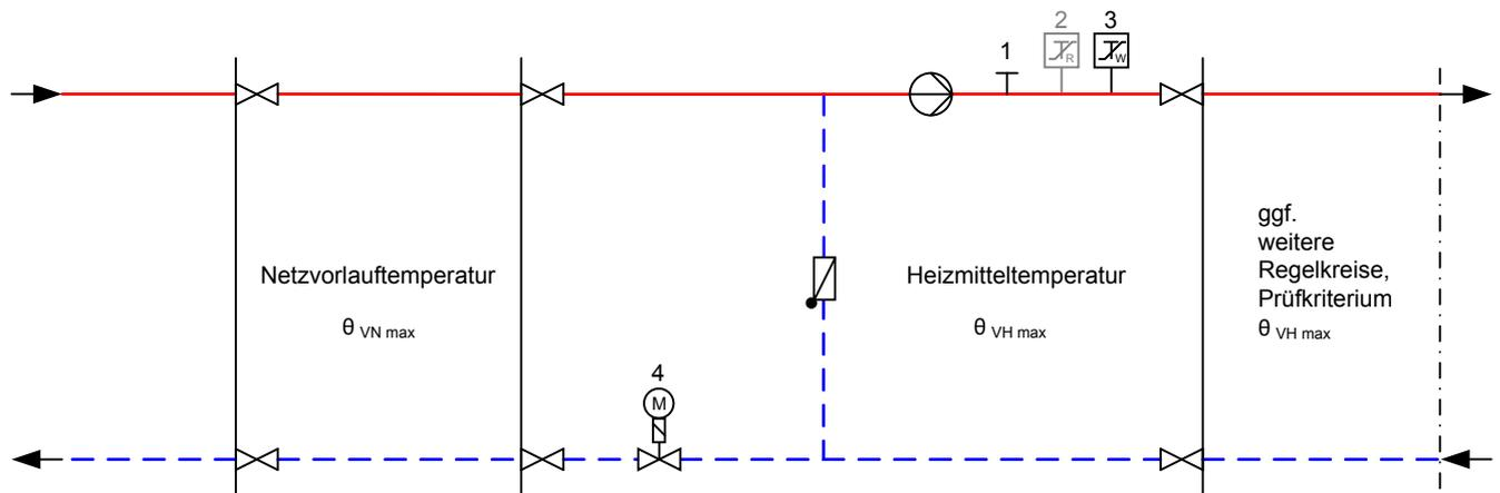
Abbildung zur Tabelle 18: Erforderliche sicherheitstechnische Ausrüstung nach Zeile 2; grau dargestellte Komponenten nicht erforderlich
