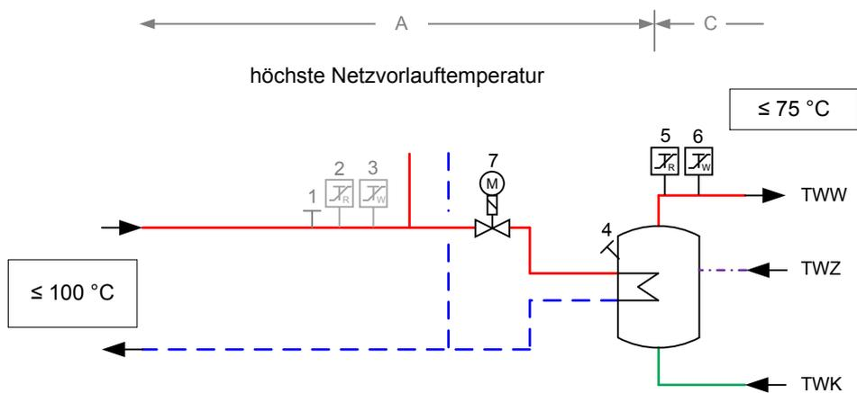
Abbildung zur Tabelle 29: Erforderliche sicherheitstechnische Ausrüstung nach Zeile 1; grau dargestellte Komponenten nicht erforderlich
