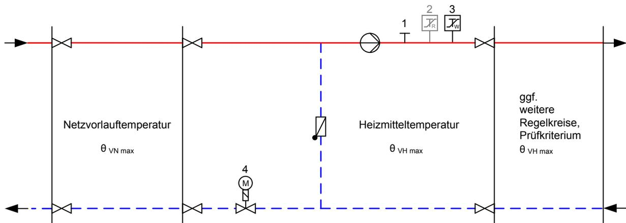
Abbildung zur Tabelle 21: Erforderliche sicherheitstechnische Ausrüstung; grau dargestellte Komponenten nicht erforderlich
