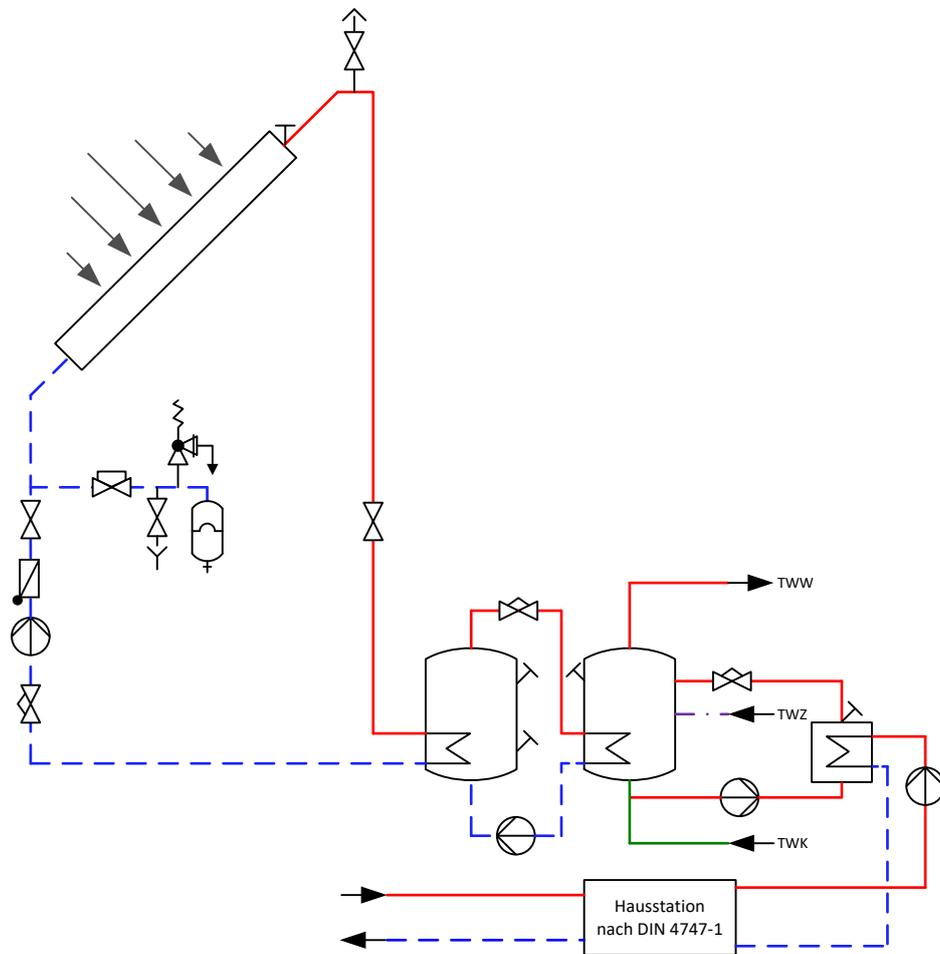
Abbildung 21: Solaranlage mit Pufferspeicher und Trinkwassererwärmer mit außen liegendem Wärmeübertrager für die Nachheizung
