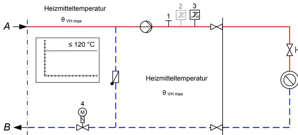
Abbildung zur Tabelle 7: Erforderliche sicherheitstechnische Ausrüstung nach Zeile 3; grau dargestellte Komponenten nicht erforderlich
