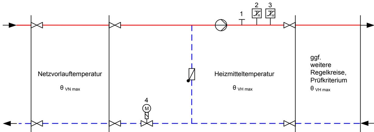
Abbildung zur Tabelle 22: Erforderliche sicherheitstechnische Ausrüstung
