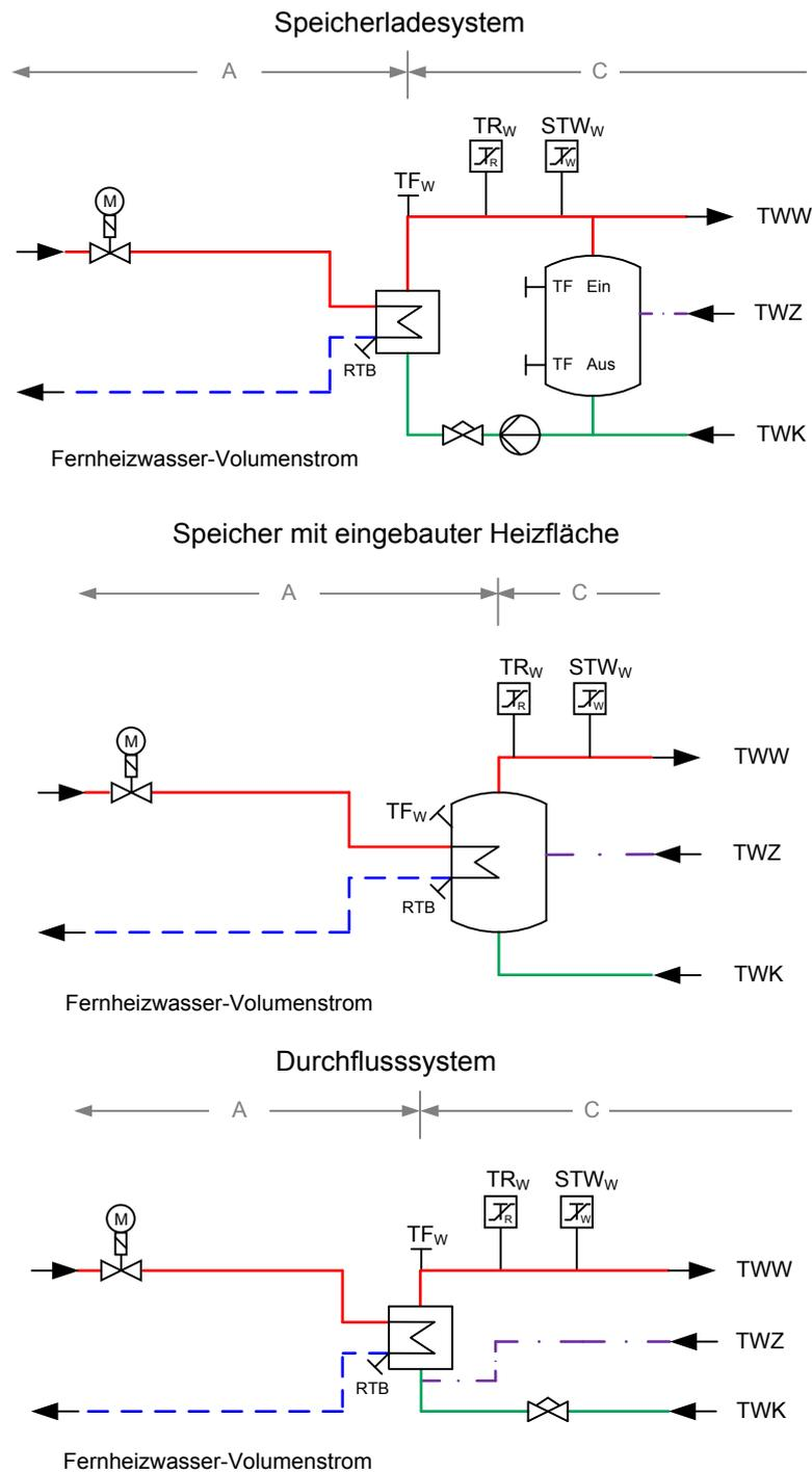
Abbildung 16: Hauszentrale-Trinkwassererwärmung
