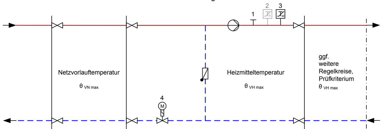
Abbildung zur Tabelle 20: Erforderliche sicherheitstechnische Ausrüstung nach Zeile 2; grau dargestellte Komponenten nicht erforderlich
