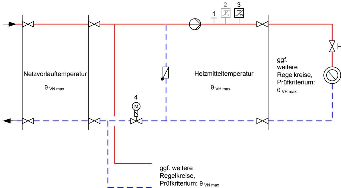
Abbildung zur Tabelle 6: Erforderliche sicherheitstechnische Ausrüstung nach Zeile 2; grau dargestellte Komponenten nicht erforderlich
