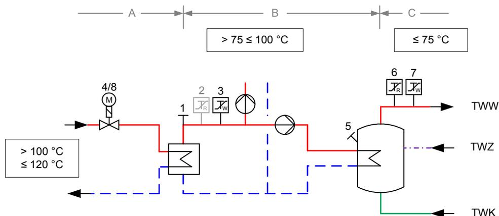
Abbildung zur Tabelle 36: Erforderliche sicherheitstechnische Ausrüstung nach Zeile 2; grau dargestellte Komponenten nicht erforderlich
