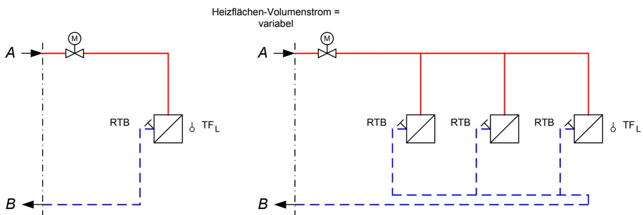
Abbildung 14: Hauszentrale-Raumluftheizung, Prinzipschaltbilder für den direkten Anschluss mit Beimischregelung
