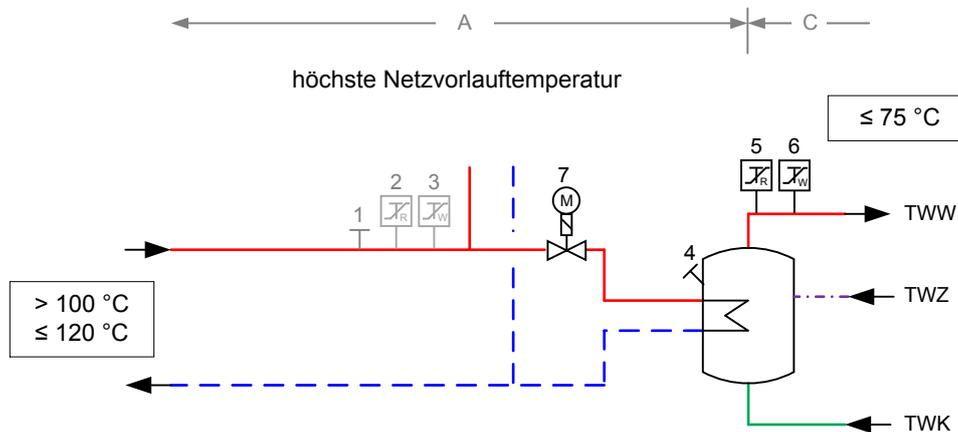
Abbildung zur Tabelle 30: Erforderliche sicherheitstechnische Ausrüstung nach Zeile 1; grau dargestellte Komponenten nicht erforderlich
