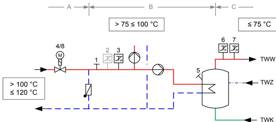
Abbildung zur Tabelle 33: Erforderliche sicherheitstechnische Ausrüstung nach Zeile 2; grau dargestellte Komponenten nicht erforderlich
